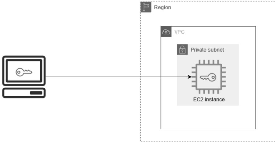
Ce schéma illustre un utilisateur qui utilise une clé privée pour se connecter à une instance EC2. La clé privée, stockée localement sur l'ordinateur de l'utilisateur, permet une authentification sécurisée lors de l'accès à l'instance. Cette méthode garantit que seuls les utilisateurs disposant de la clé privée correspondante peuvent établir une connexion à l'instance.
