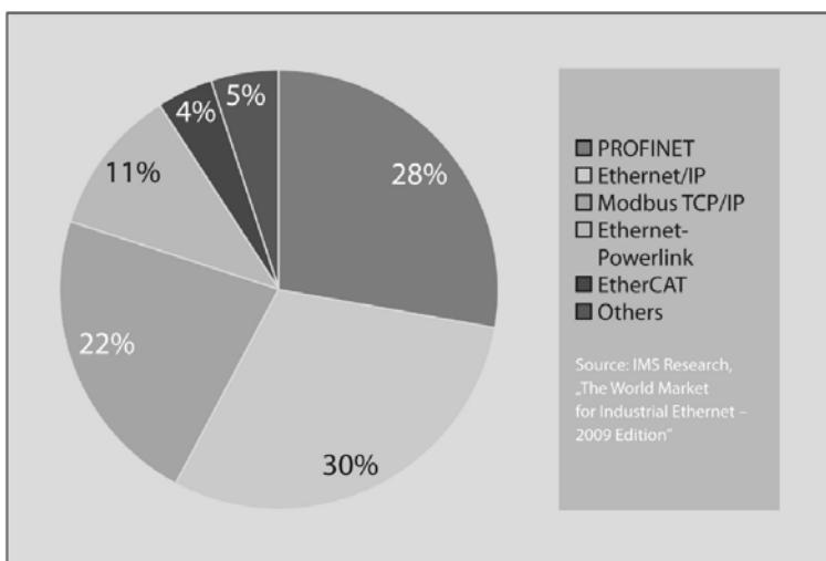
Vous voyez ici clairement la domination du réseau Ethernet avec plusieurs protocoles présents sur celui-ci. Cette progression d'Ethernet n'a cessé d'évoluer jusqu'à nos jours et Ethernet devient progressivement un protocole incontournable.
