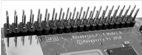
Sur cette photo du connecteur GPIO J8, la broche 1 est à gauche au premier plan. La pastille de cette broche 1 sous la carte est carrée. Le schéma qui suit présente le connecteur GPIO (J8) vu de dessus.
