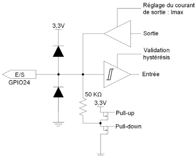
La broche d'entrée/sortie (E/S GPIO24) se trouve à gauche du schéma. À droite de ce point d'accès physique, les composants représentés sont dans le SoC. Toutes les E/S GPIO sont basées sur le même circuit.
