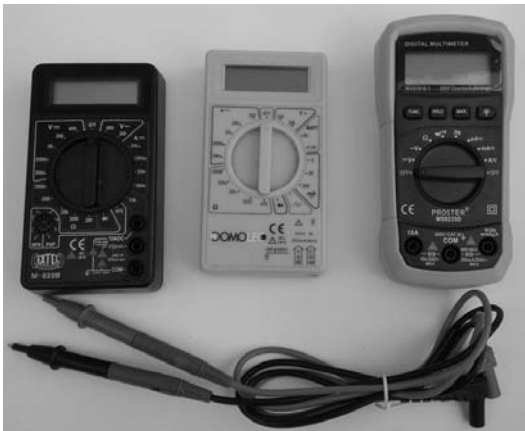
Exemples de multimètres (celui de droite est auto-range)
