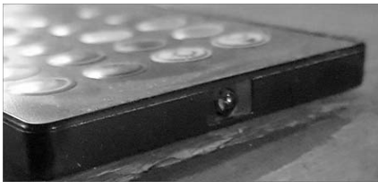
Télécommande IR avec sa LED d'émission
