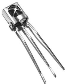
Récepteur IR VS1838B
