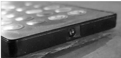
Télécommande IR avec sa LED d'émission
