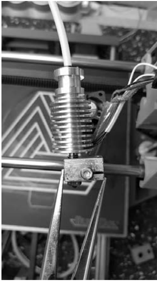
Tête d'impression E3DV6 montée
