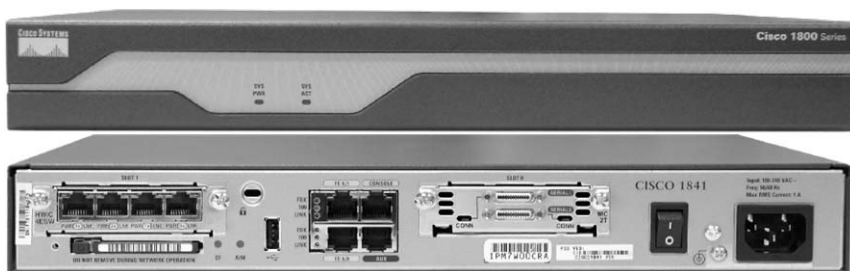
LED et ports d'un routeur Cisco 1841
